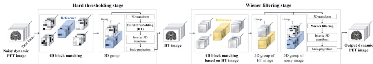
図1 提案 BM5D の処理の流れ。ハード閾値処理(左), ウィーナーフィルタリング(右)の2ステップからなる。
