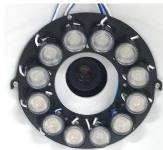
図 2 TIAS 内部に設置した励起光源
