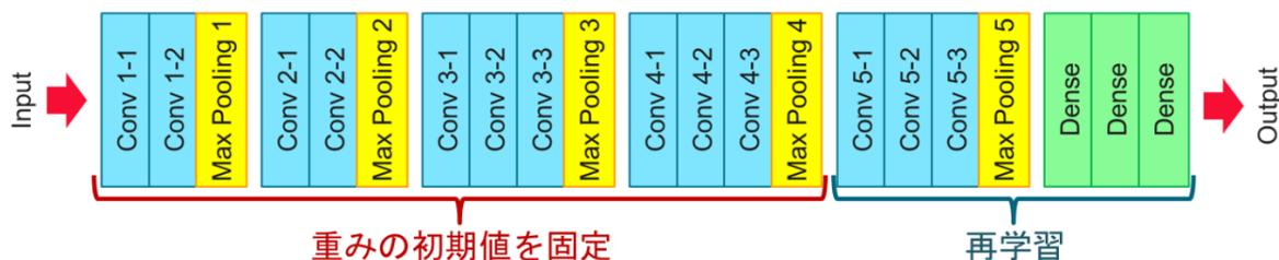
図 1 VGG16 の構造
